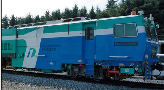
マルチプルタイタンパー(通称マルタイ)は、世界中で導入されている大型保線機械です。線路上を列車が走行する事により生じる線路の歪みをミリ単位で計測修正を行い、「レールクランプ」でレールを持ち上げ、道床(バラスト)を鉄の爪で突き固めて線路の性能を回復させます。日本国内仕様ではタンピング作業部に「騒音防止板」を装備しています。こちらの製品は、ブラッサー & トイラー社製「09-16型」のプロトタイプとなります。
